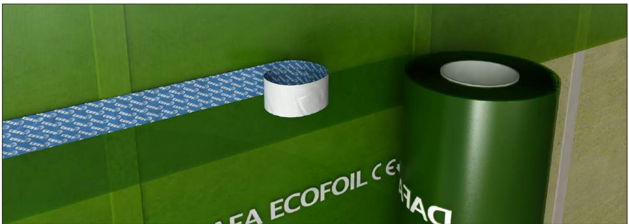
Allgemeines Prinzip – Leichte Stahl-Außenwand. 1. DAFA EcoFoil mit doppelseitigem Klebeband auf die Stahloberfläche auftragen. 2. Ggf. können z-Profile mit Vorbereitung für elektrische Installationen usw. montiert werden.
