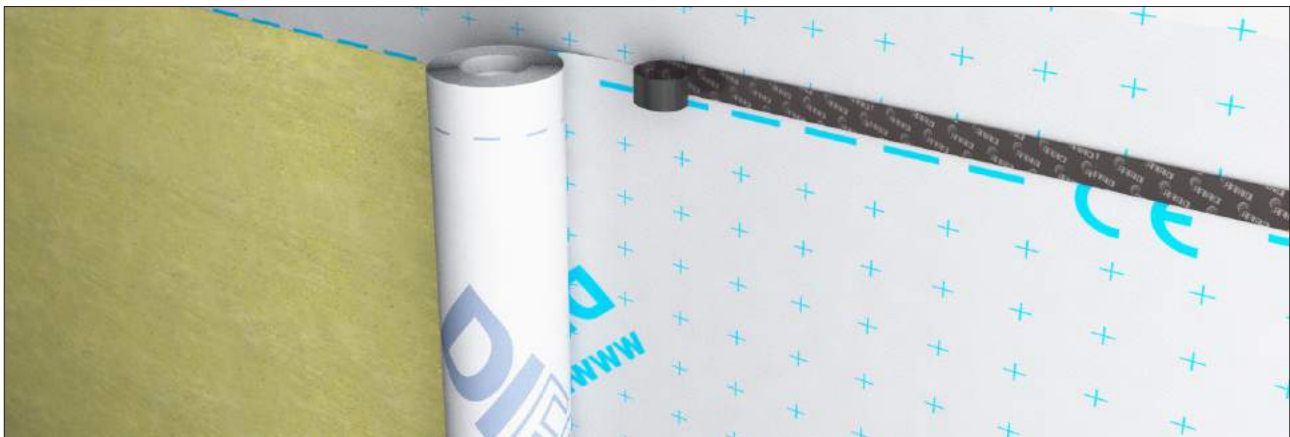
Monter le film écran freine-vapeur avec des chevauchements et coller avec le ruban noir DAFA UV écran freine-vapeur.
